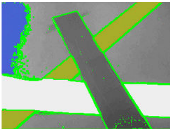
Figur 3-6: Outputbillede af testopstillingen i almindeligt dagslys fra vinduet. Kantdetektering må siges at virke markant bedre end før.
